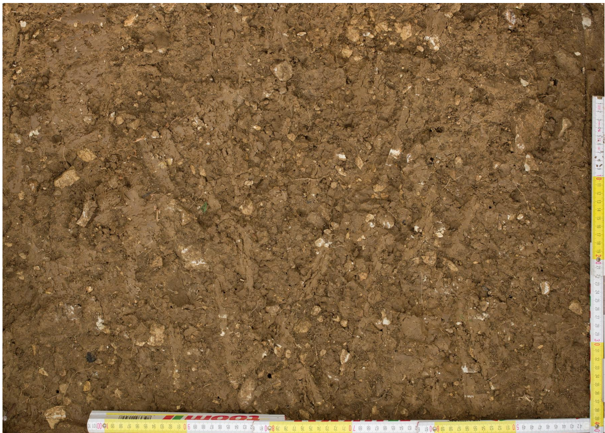
Bild 5: horizontal Bodenschnitt Mulchsaat (Wiederholung 3, ca. 21 cm Tiefe)
