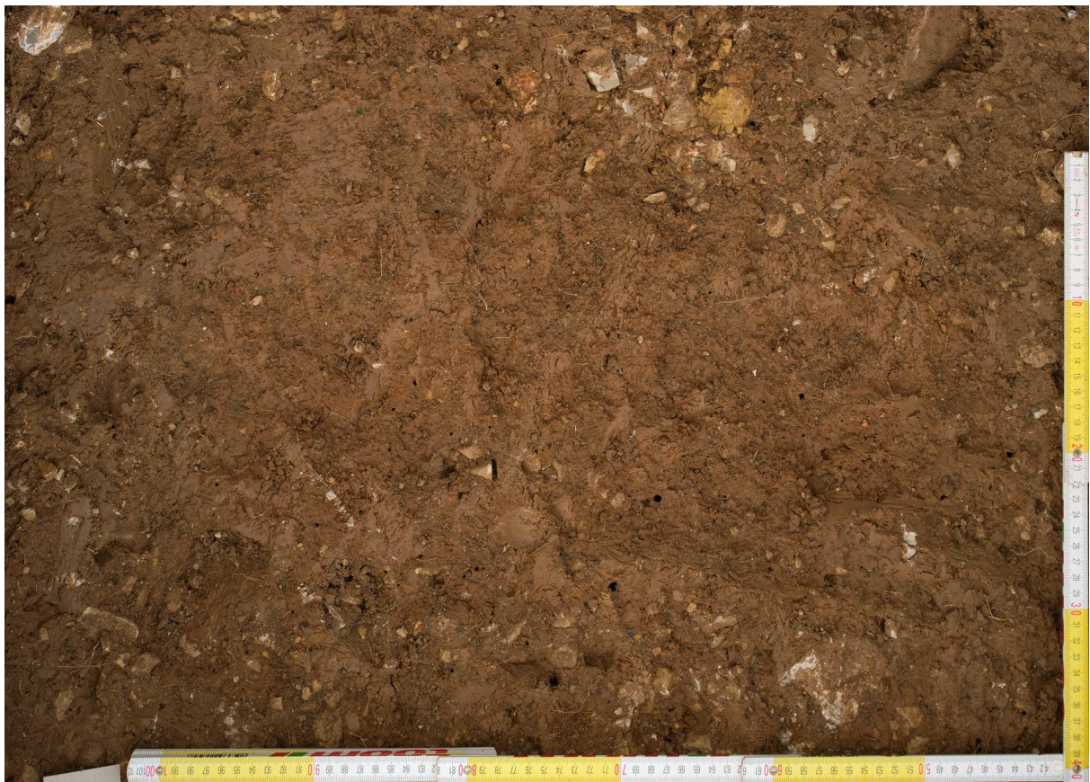
Bild 6: horizontaler Bodenschnitt Pflug (Wiederholung 3, ca. 24 cm Tiefe). Bei dieser Wiederholung zieht sich eine fast steinfreie Zone aus Lösslehm quer durch das Bild.
