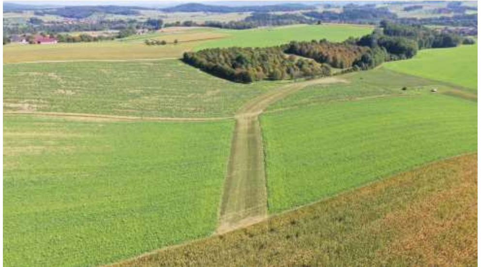
Abb.: Begrünter Abflussweg in einer Tiefenlinie des Seitengrabenbach-Einzugsgebiets in Petzenkirchen, Niederösterreich (©BAW, Matthias Konzett)
