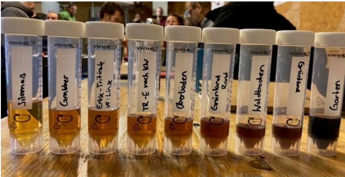
Mittels 1 molarer Natronlauge werden organische Verbindungen „ionisiert“ und in Lösung gebracht. Diese Verbindungen haben eine gelblich-braune Farbe und wurden früher als „Huminstoffe“ bezeichnet.
