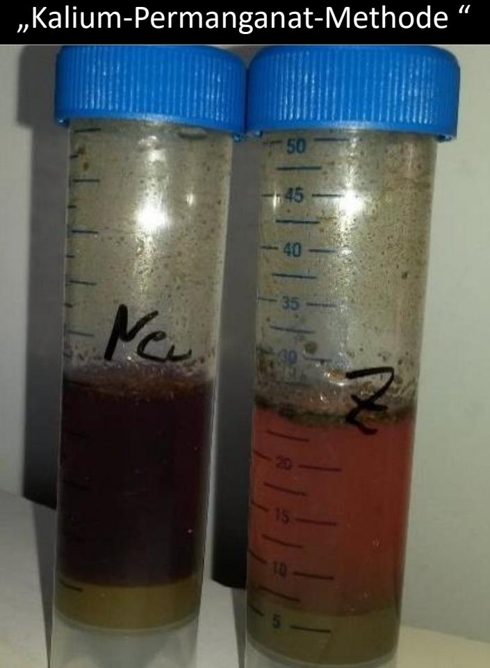
Der Farbverlust der violetten  $\text{KMnO}_4$ -Lösung zeigt die Menge an leicht abbaubaren (=oxidierbarem) Kohlenstoff.
