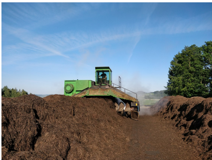
Kompostwender im Einsatz - Mit Kompost können regionale Kreisläufe geschlossen werden. Anfangs ist bei der Kompostierung von Klee gras und Wiesenschnittgut häufiges Wenden notwendig © Bio Forschung Austria
