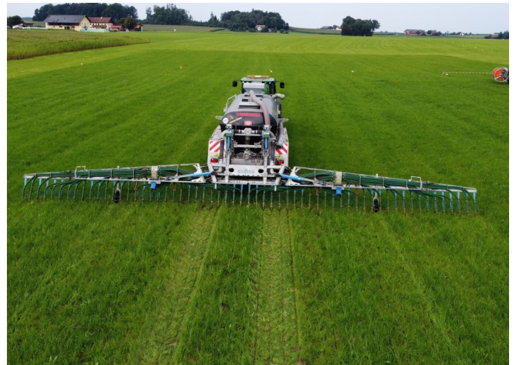
Die Ausbringung von separierter Gülle in angewachsene Bestände optimiert die Futterqualität und die Nährstoffeffizienz und reduziert die Nachbarschaftskonflikte. © BWSB
