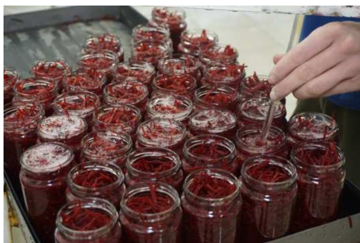
Die roten Rüben werden händisch eingefüllt, mit dem Sud aufgefüllt, bevor sie dann in Kisten in den Solarpasteur kommen.
